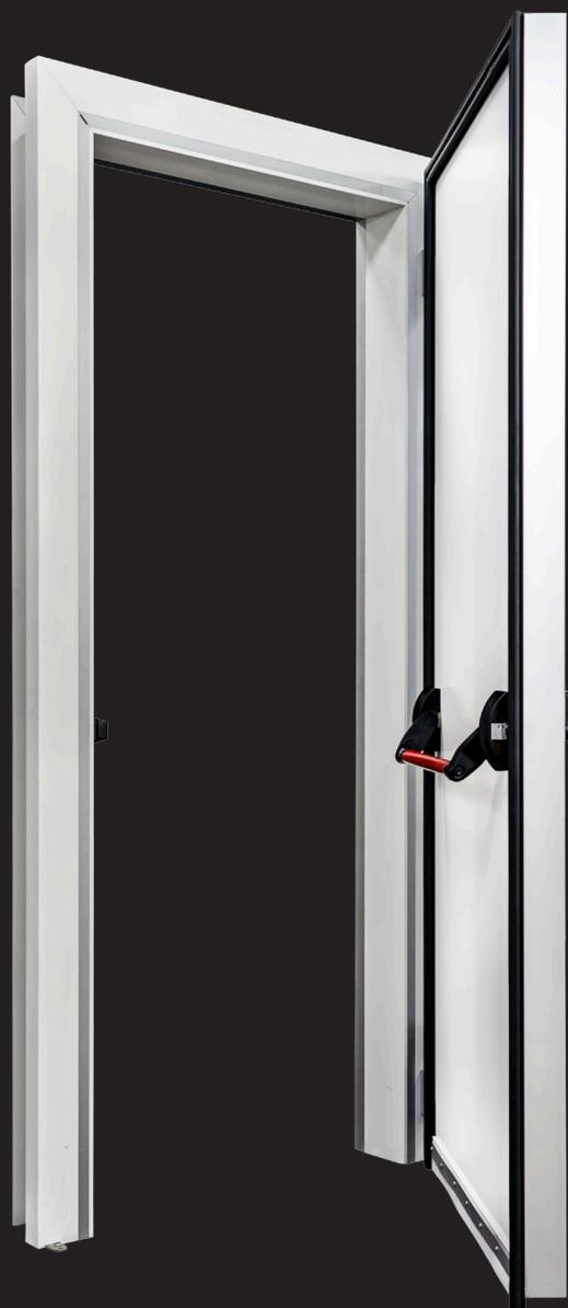
La porta frigorifera a cerniera è costituita da un pannello/ tampone di spessore adeguato alle esigenze di utilizzo (70-100-150 mm) e da un telaio. Nel caso di piccole celle frigorifere la porta (di larghezza inferiore a 980 mm) può essere montata direttamente su pannello che funge da sembrante.
